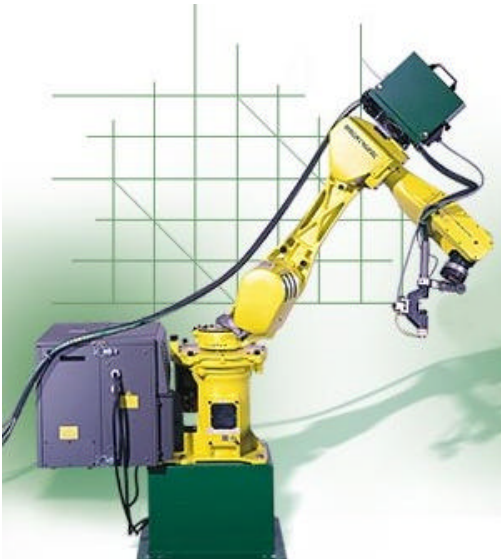
Robot-Plasma-Lassen met kouddraadaanvoer Toorts: ABIPLAS WELD 150 W Draadaanvoer: Master Feeder System
